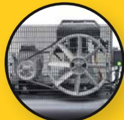
Starker zuverlässiger Keilriemenantrieb
